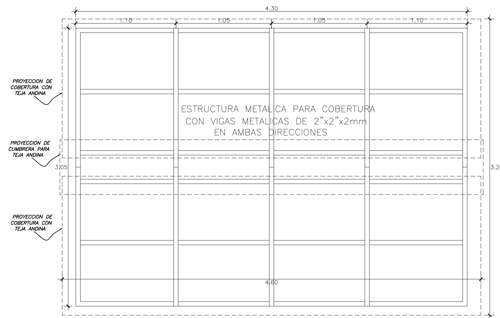
ESTRUCTURA PARA COBERTURA DE MURO ESCALA 1/25
